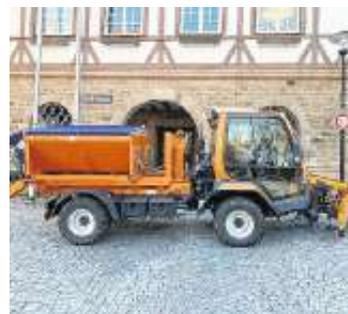
Neu an dem Fahrzeug ist, die Absetzmuldenteknik. Hierdurch lassen sich Schüttgüter auf den verschiedenen Mulden leichter transportieren.
