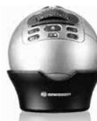
Bei dem Gerät, das hier abgebildet ist, handelt es sich um ein Mini-Planetarium. Das bewegte Projektionsbild wirft den Sternenhimmel an die Kinderzimmer-Decke, auf zwei verschiedenen Projektionsscheiben sind mehr als 8.000 Himmelskörper gespeichert.
