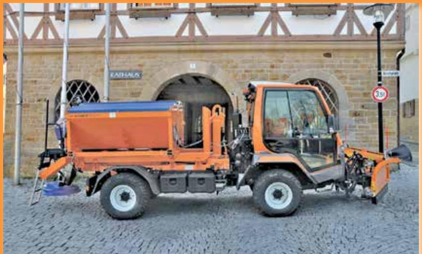
Neu an dem Fahrzeug ist die Absetzmuldentechnik. Hierdurch lassen sich Schüttgüter auf den verschiedenen Mulden leichter transportieren. Außerdem kann das Fahrzeug durch das Aufsetzen des Streugerätes, das ebenfalls auf einem Muldenträger aufgebaut ist, sehr schnell zum Streueinsatz umgerüstet werden.
